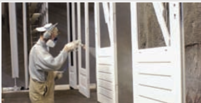
Aflakken en beglazing onder geconditioneerde omstandigheden in de fabriek
